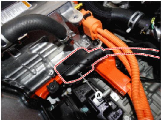
10. 拆卸电源导线固定支架(A)。
