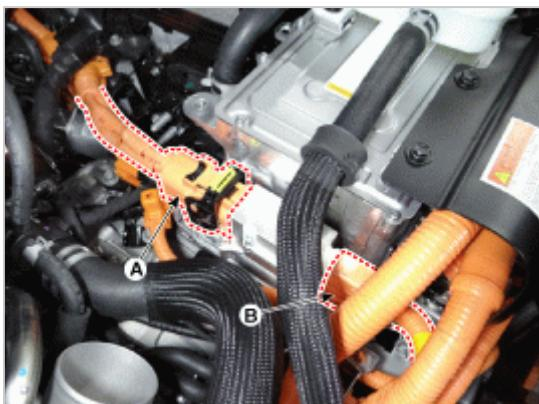
按下列顺序拆卸逆变器电源导线。
